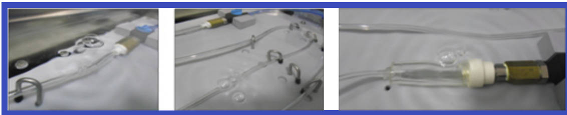
Ilustración 7. Ensayo detección de fugas en equipos de macrogoteo
