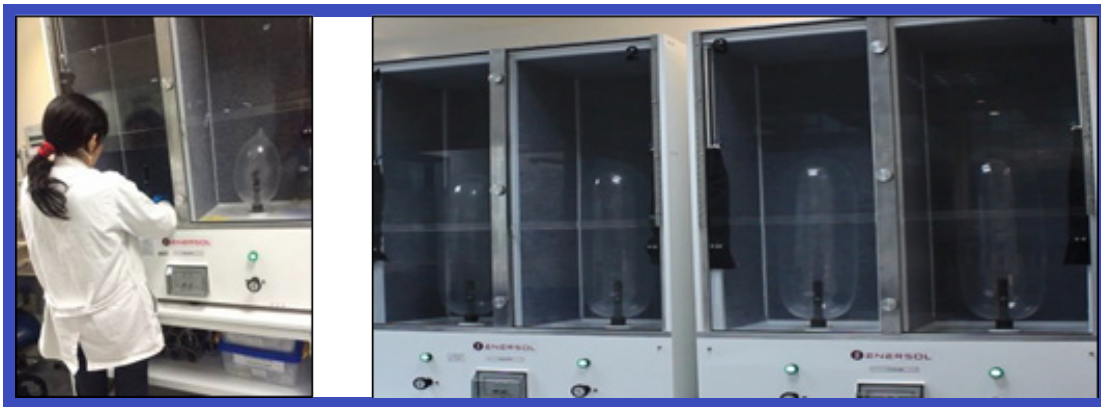
Ilustración 4. Ensayo de volumen y presión de estallido en preservativos
